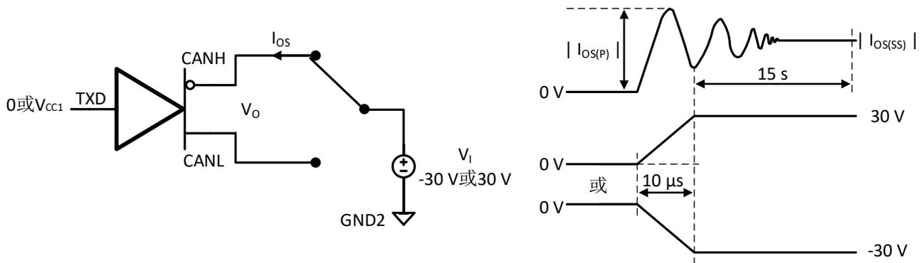
图 8-9 输出短路电流测量电路和波形
