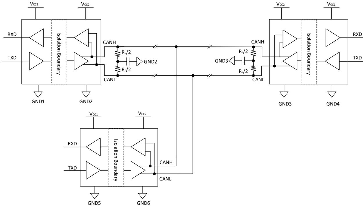
图 10-2 基于 CA-IS305x 的典型 CAN 总线拓扑
