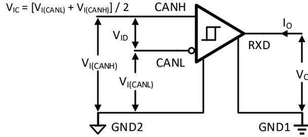
图 8-4 接收器输出电压、电流测试条件
