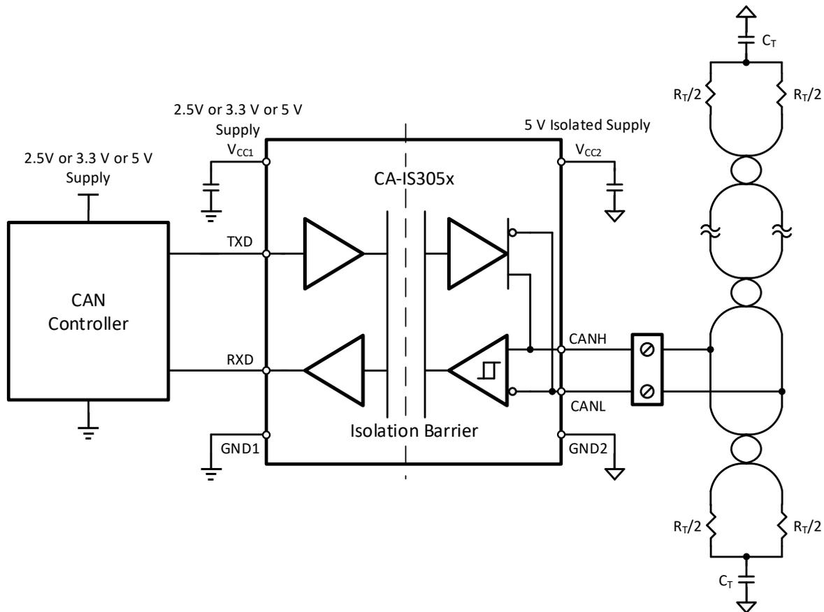
图 10-1 基于 CA-IS305x 的典型隔离式 CAN 节点
