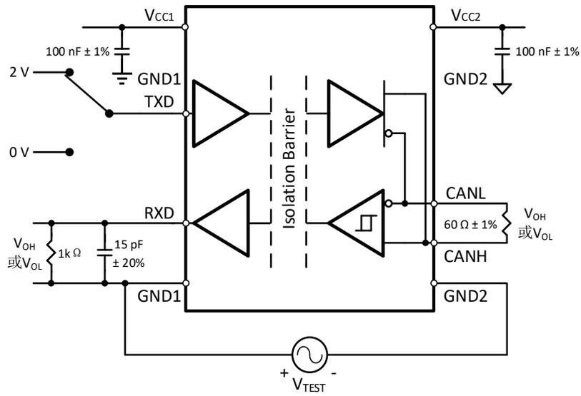
图 8-10 共模瞬态抑制(CMTI)测量电路
