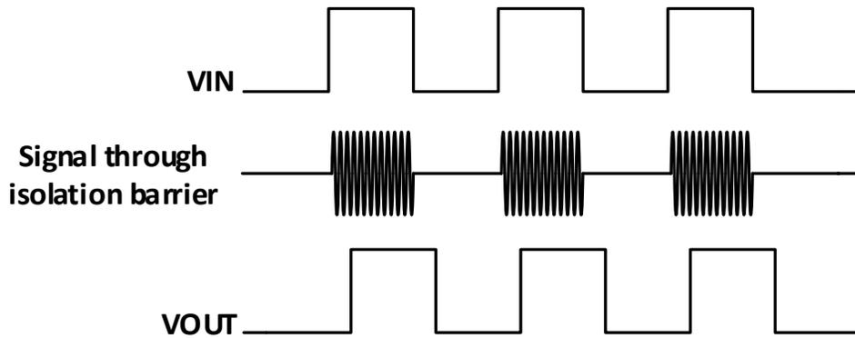
图 9-2 OOK 开关键控调制方案波形示意图
